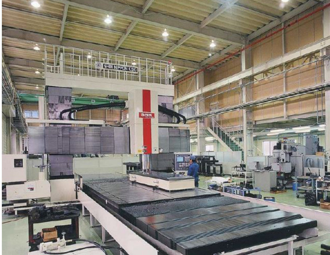
五面加工機：門型マシニングセンター
