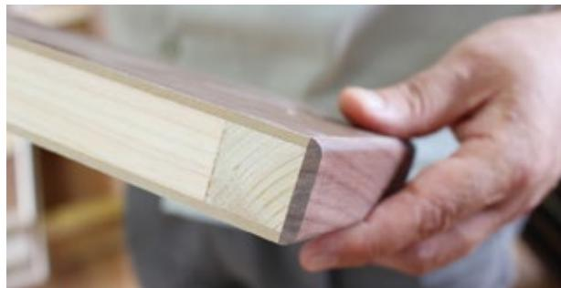
原板に天然のウォールナットを貼り合わせた加工済み材料の断面
