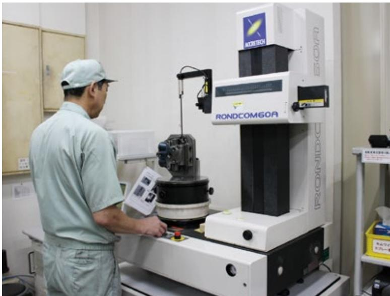
高性能試験機でホーン加工された製品の精度を厳しくチェック
