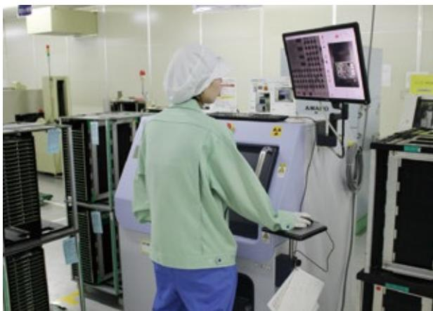
導入したSMX-1000plusによるX線透過検査の様子
