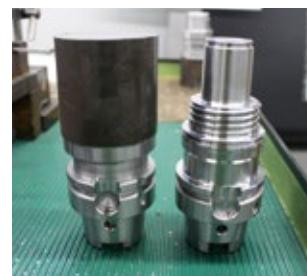
主力製品の「精密マイクロンチャック」 左が施削前、右が施削後の製品
