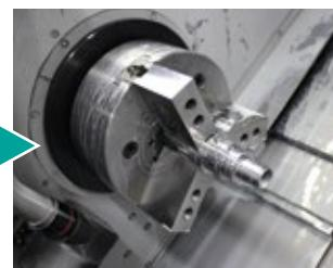
製品を固定して精密な施削加工を行う
