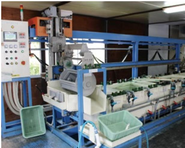
特殊形状の細孔・深孔・隙間形状金属部品を洗浄する装置
