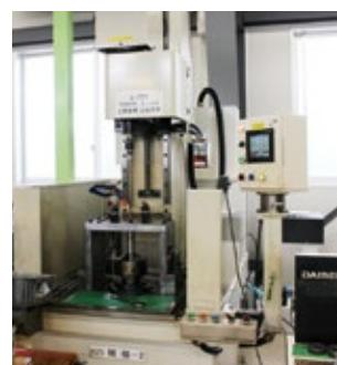
次に仕上げ加工機で精度の高い加工を施します
