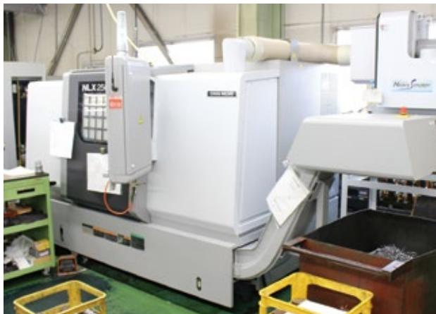
導入したNC旋盤設備(森精機製 NLX2500)
