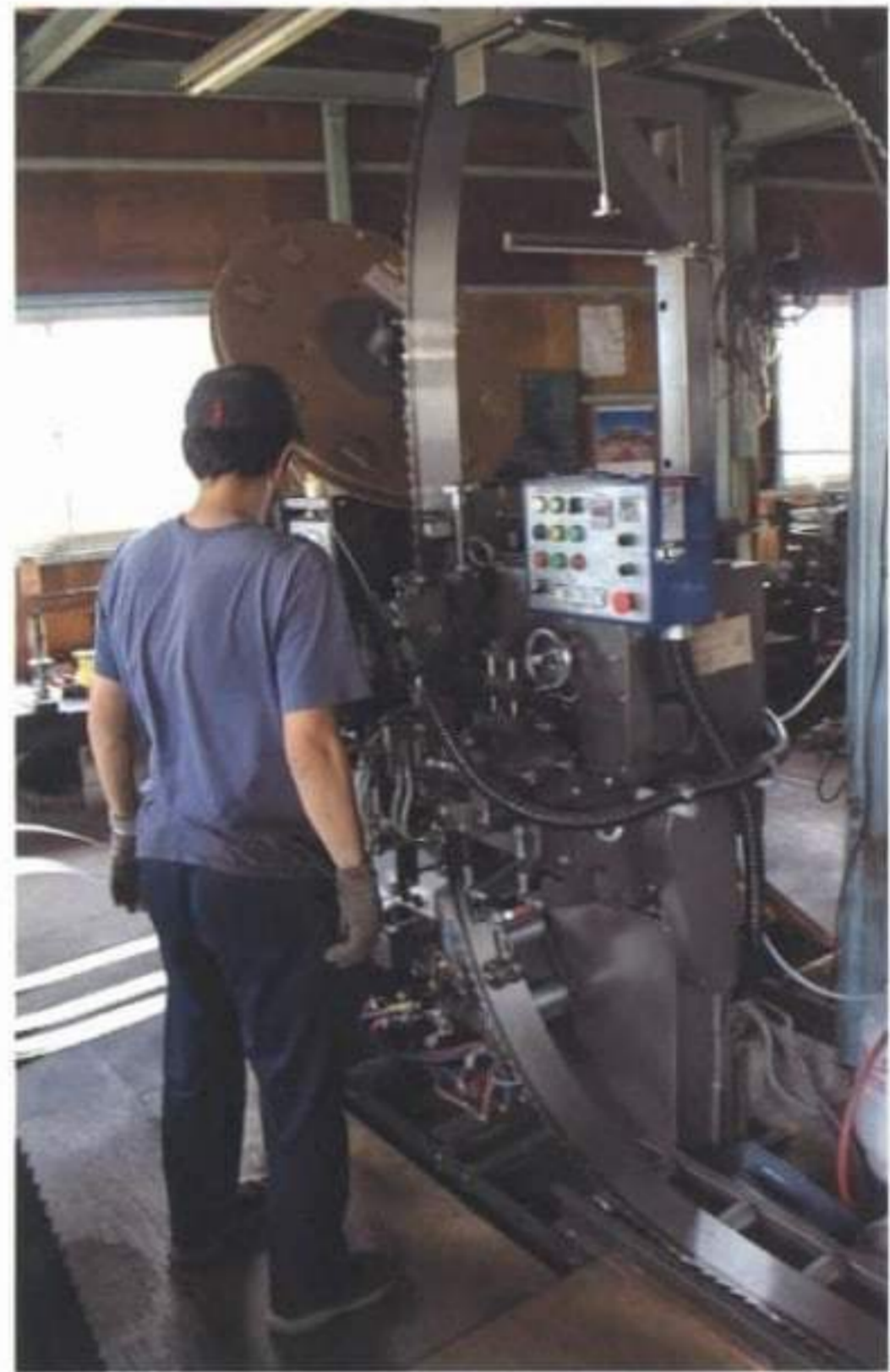
▲自動的に溶着するため作業時間が半減
