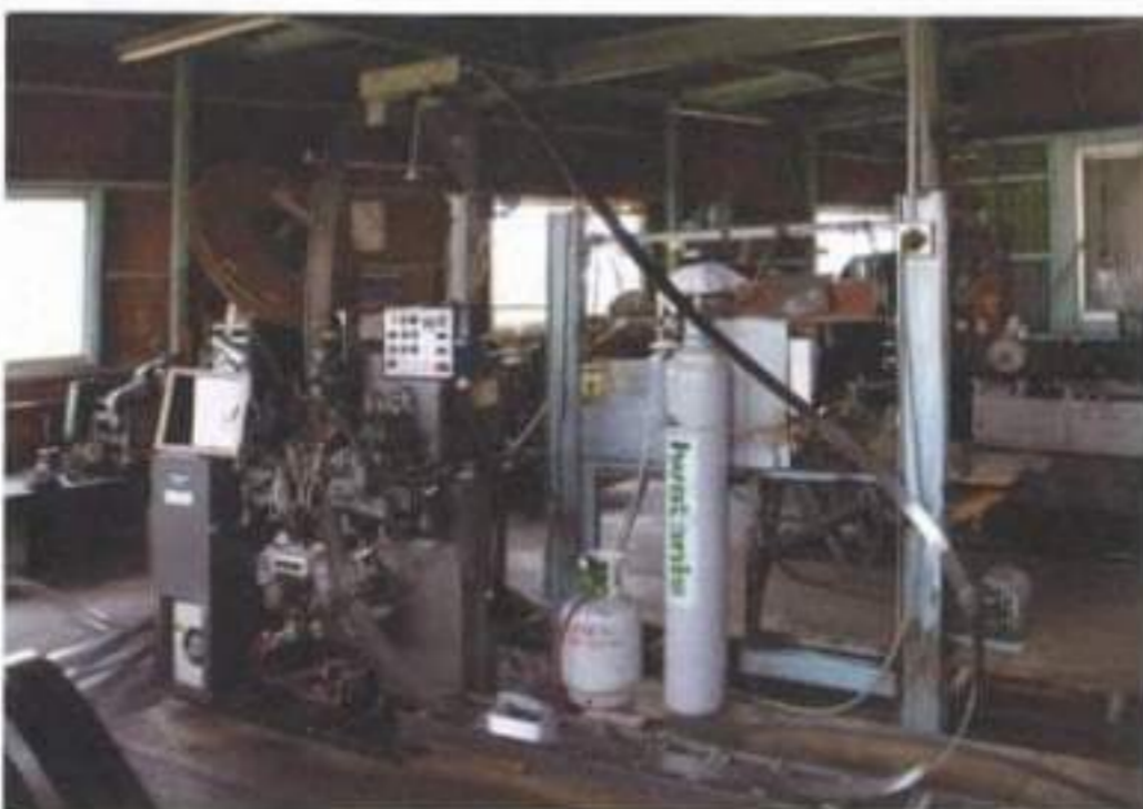
▲新たに導入したステライト・ハイス帯鋸自動溶着機
