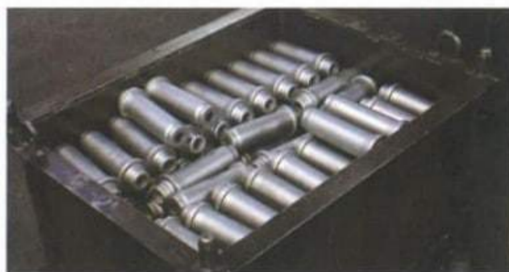
▲ 独自技術による長尺中空鍛造品
