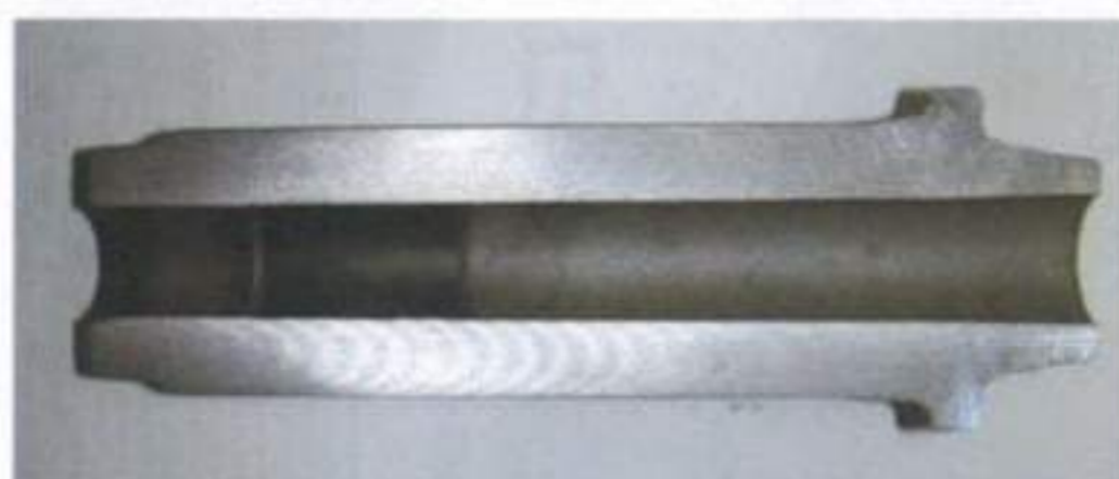
▲ 長尺中空鍛造品の断面図。黒い部分が酸化スケール残り
