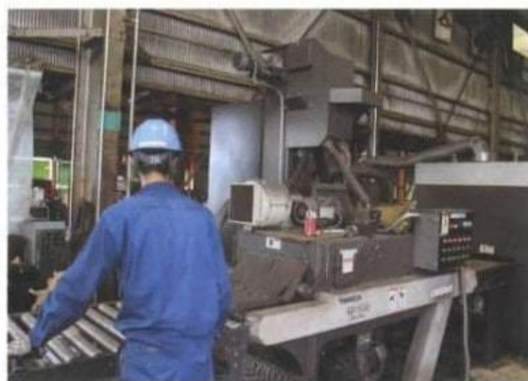
▲プレシェーバー（バリ取り機）とショットブラスト機をライン化
