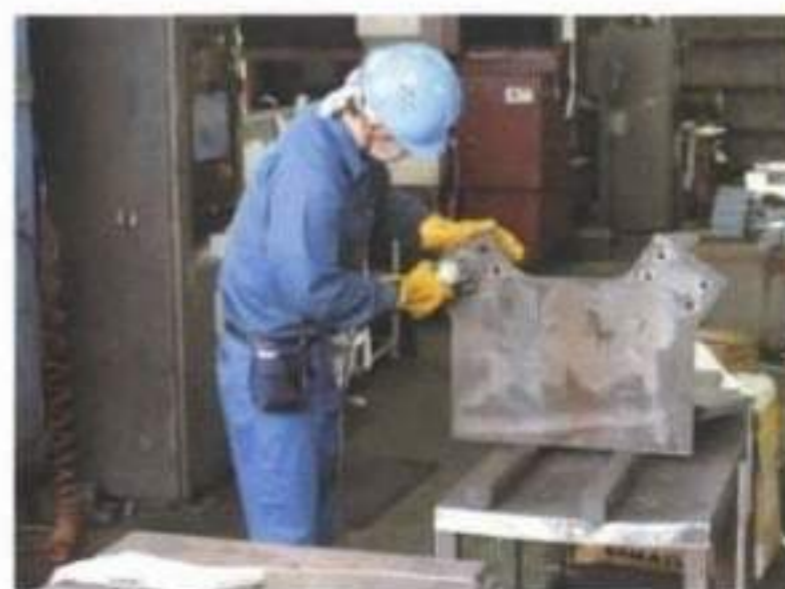
▲手作業でのバリ取りは時間とコストがかかっていた
