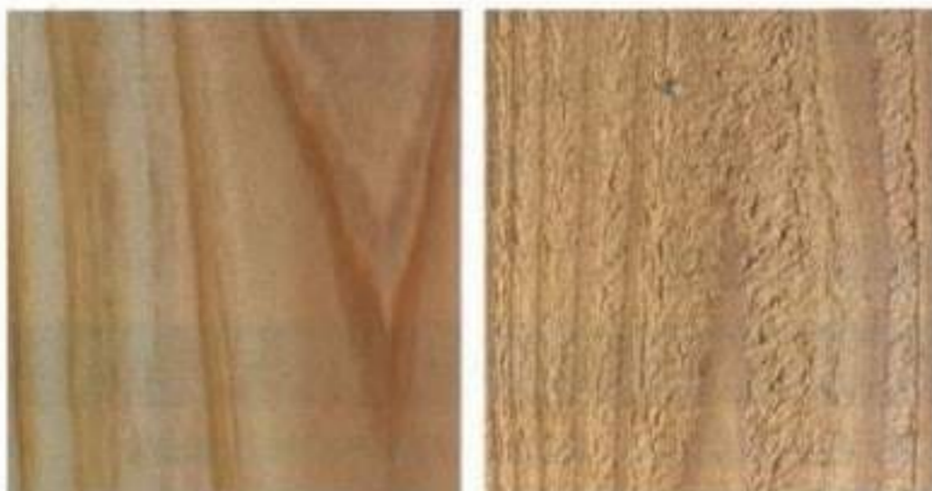
▲左がハイス加工後の鋸歯で切断した断面(右は切断前)
