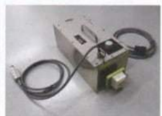
▲雑音端子電圧を測定する疑似電源回路網
