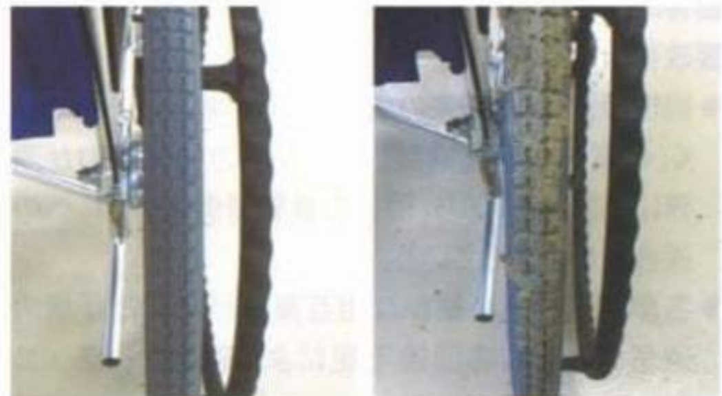
▲「車いす両輪専用洗浄機」で洗浄した車輪(右は洗浄前)
