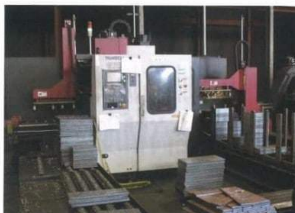
▲フルオートボーラー(全自動オートドリルマシン)のストック量を従来の3倍に
