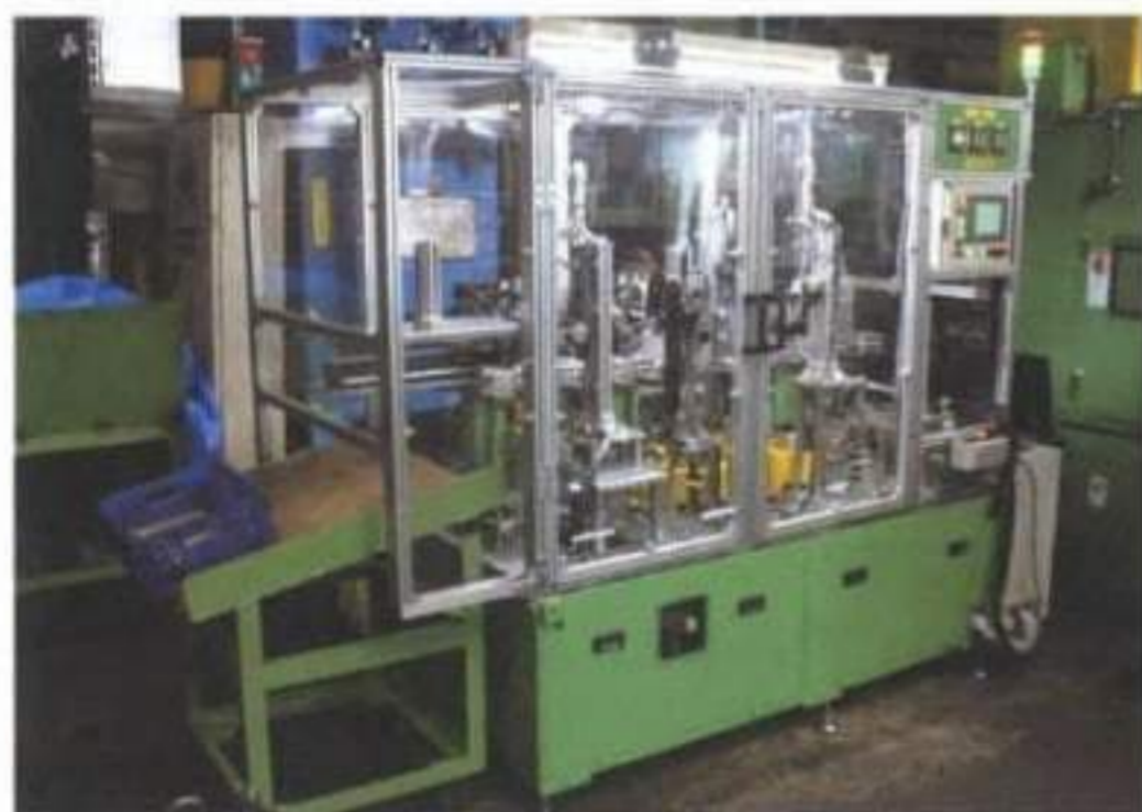
▲長尺中空鍛造品専用の全自動検査装置を開発
