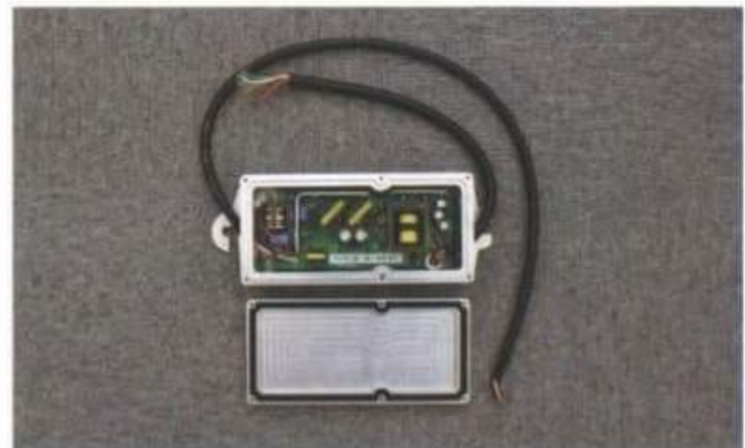
▲完成したLED用電源装置
