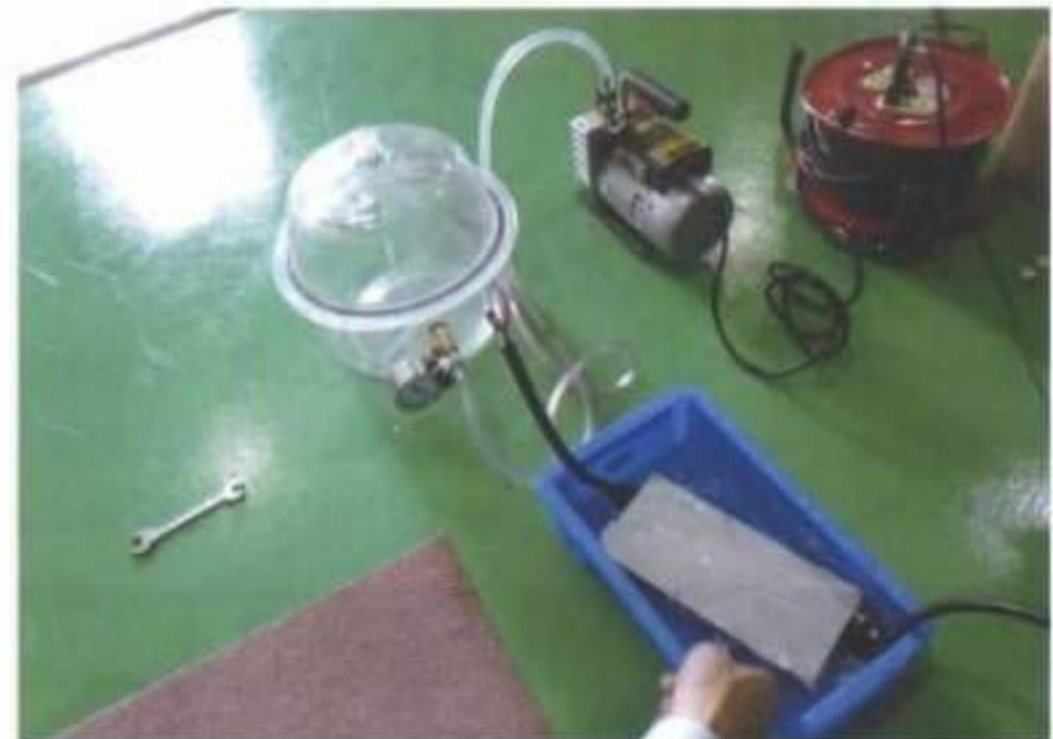
▲LED用電源装置内部を真空ポンプを用いて減圧し実施した防水試験
